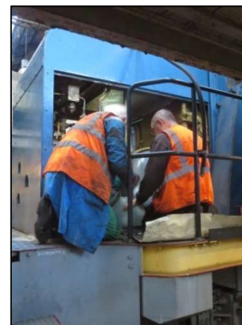
Épreuve hydraulique des deux réservoirs frein
