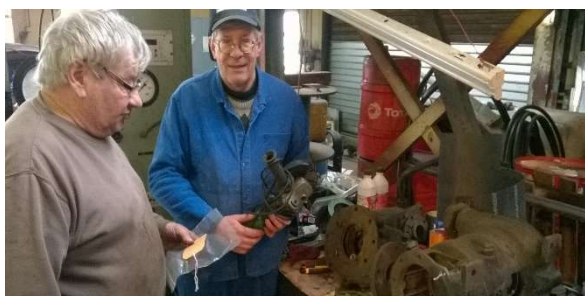
Au chevet de la pompe à eau froide de la chaudière
