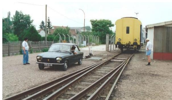
Pas de locotracteur en juillet 1994 à Cosne : la manœuvre du fourgon chaudière est assurée par la 204 de Philippe Brochet ! Les déplacements de la R se font par gravité et la remonte au tirefort, un exercice particulièrement physique et laborieux.
