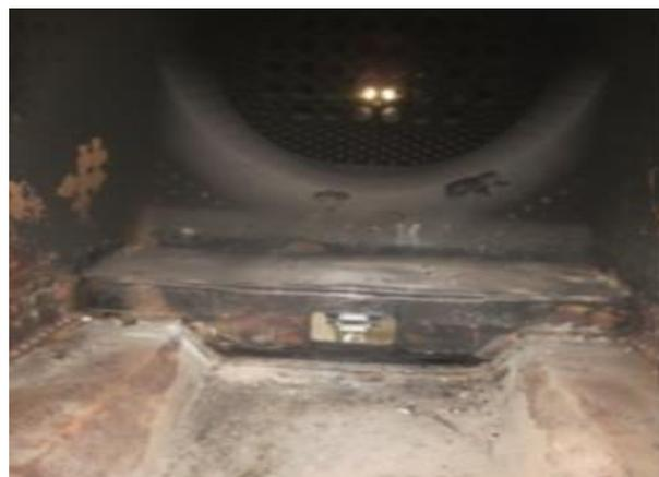
*Contraste : le foyer de la 141R840 et ses tôles mises à nu après le débriquetage ; au fond, le brûleur et le jour de la boîte à fumée vu à travers les tubes.*
