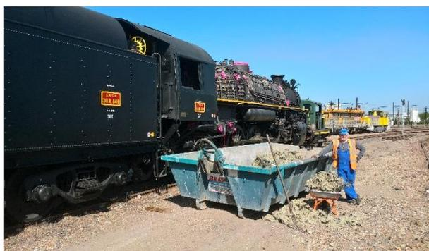
*Eric à la manœuvre : près de 3 tonnes de déchets provenant du calorifugeage de la machine et du briquetage du foyer sont partis à la benne de recyclage.*
